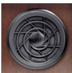
**Variovent systém** zlepšuje kvalitu zvuku v oblasti stredných tónov a vyšších basov. V ozvučnici strednotónových meničov sú umiestnené dva Variovent otvory, fungujú ako vzduchové prieduchy s definovaným odporom a tak znížujú rezonancie. Dynaudio používa Variovent ozvučnice už od začiatku postupne ho veľmi zdokonalili.
